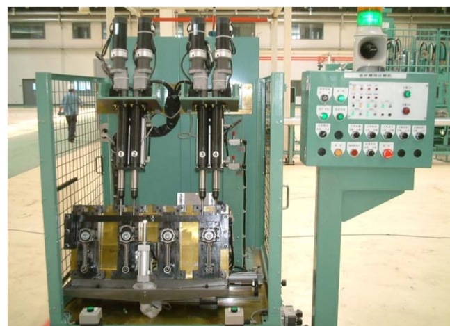
线外单机，用于连杆活塞组合安装前
