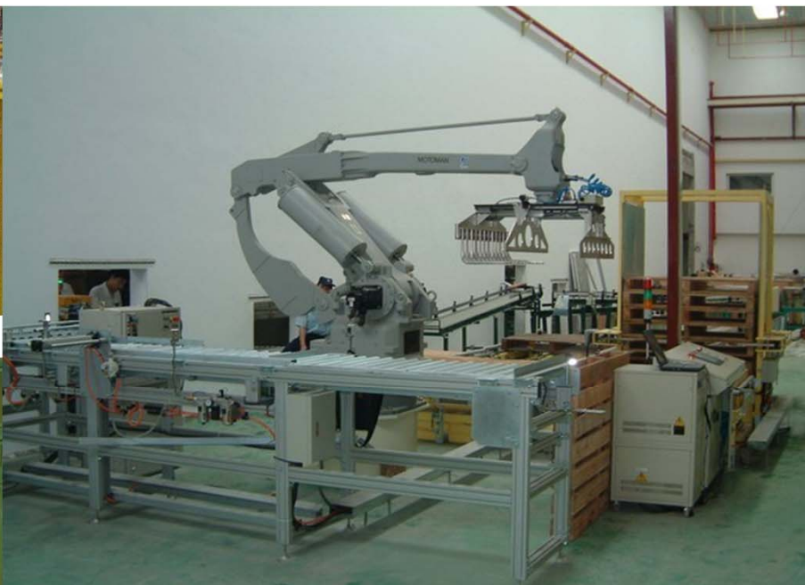
机器人移栽、码垛、及与加工机床配合使用
