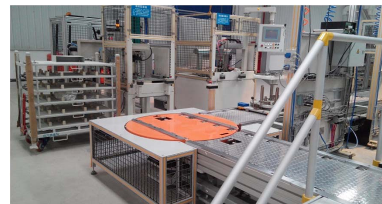
滚筒式自动轨道+自动回转台
