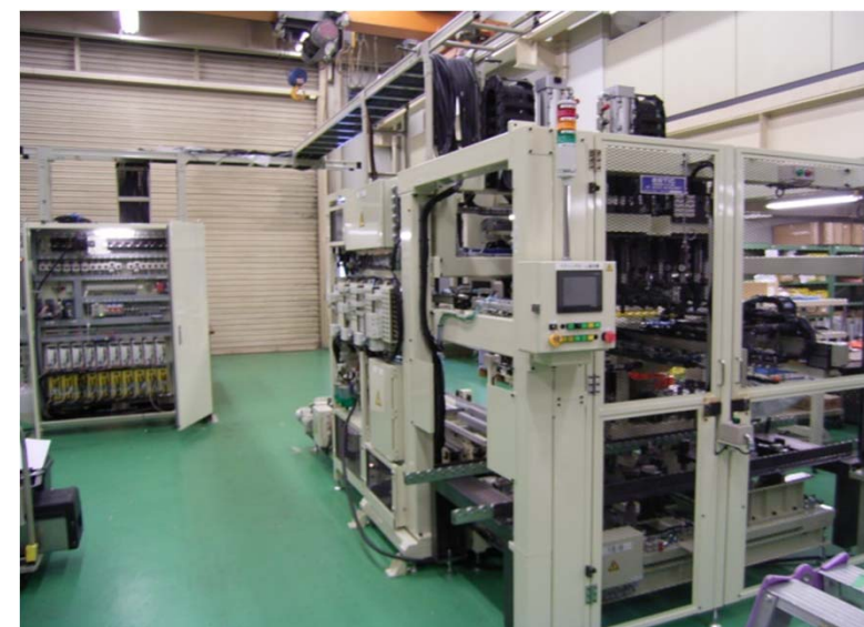
自动化拧紧装配线：可根据用户需求实现自动上料、输送、翻转、回转、自动定位、自动上螺丝、预拧紧、拧紧、刻印、自动下料等工序。
