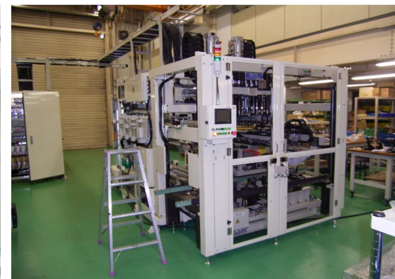
自动化拧紧装配线：可根据用户需求实现自动上料、输送、翻转、回转、自动定位、自动上螺丝、预拧紧、拧紧、刻印、自动下料等工序。
