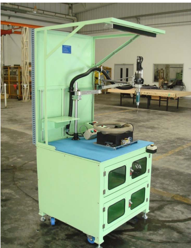
线外单机：用于拧紧安全气囊
