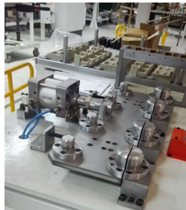
连杆装配前需要将连杆本体与瓦盖拆开
