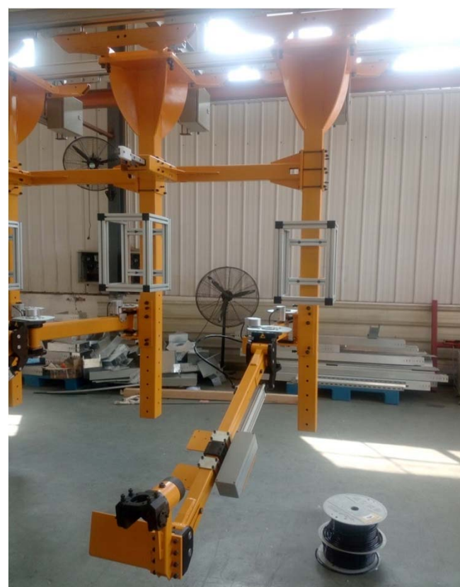
汽车底盘、减震器等拧紧机抗扭力臂
