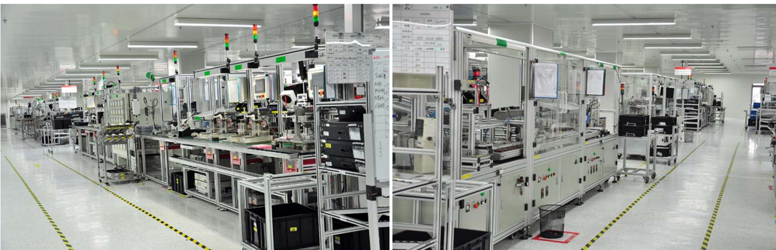
全自动组装测试生产线 电子电气元件的组装，热元件模拟测试，激光打标，贴标
